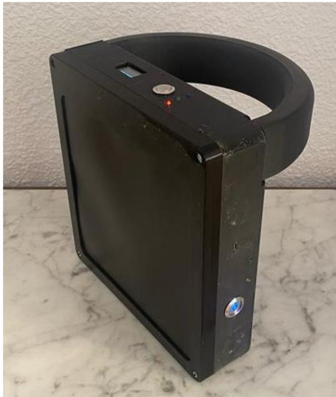
*Figura 2-3. Lector RFID físico montado*
