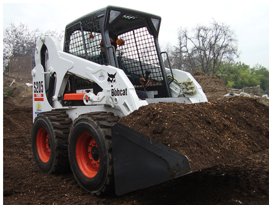
Figura 9. Recogida de material con pala bobcat.
