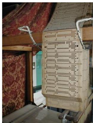
Figura.- Detalle de las tarjetas perforadas empleadas en el telar de Jacquard. (Cortesía de WIKIMEDIA)
