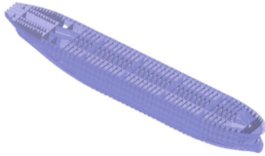
Figura 1-7. Estructura casco de un VLCC. Fuente: [1].
