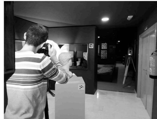
Figura 4. Toma de datos realizada con fotogrametría.
