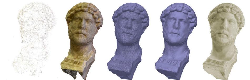
Figura 8. Resumen fases de modelizado. Nube de puntos de enlace, nube de puntos densa, malla alámbrica, malla con superficie y malla texturizada.
