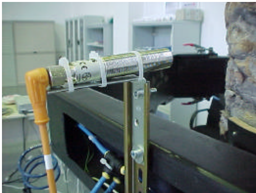
Figura 5: Sensores de ultrasonidos empleados.
