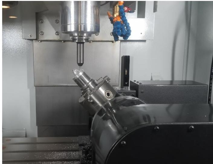
Figura 4.3: Mecanizado del rodete
