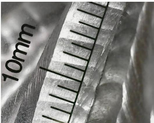
Figura 5.8: Imagen reglada del microscopio de la zona B para interpolación lineal
