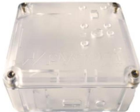
*Figura 73: Carcasa para el nodo*
