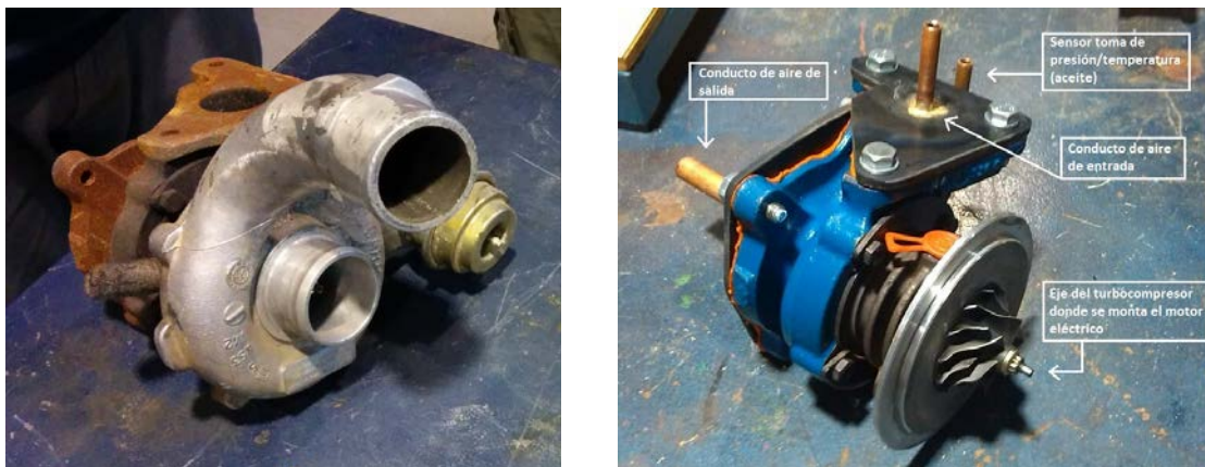
Figura 3 – Turbocompresor adaptado al equipo docente basado en el efecto Joule-Thomson
