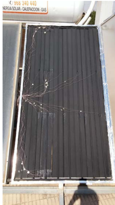
Figura 3: Disposición de termopares sobre el colector
