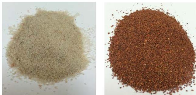
Figura 2: Fotografías de los materiales utilizados: arena y GR50 respectivamente.
