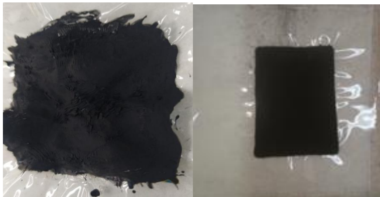
Figura 8.1. Comparativa MEA fabricada por pincel vs MEA fabricada por electrospray
