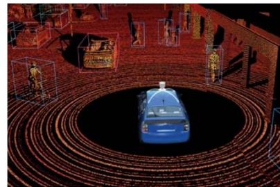
Figura 15. Imagen 3D ejemplo LIDAR
