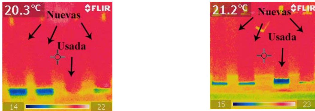
Figura 5: Termografías realizadas tras poner en contacto con el agua muestras de tejidos nuevos y ya utilizados en ensayos previos de lino (izquierda) y poliéster (derecha).
