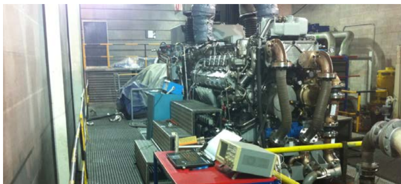
Figura 1. Motor NAVANTIA-MTU 12V396 en banco de pruebas
