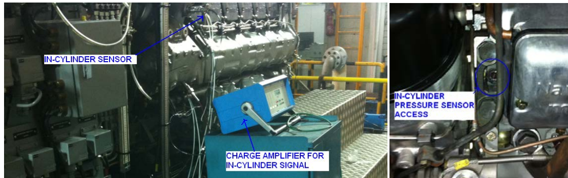
Figura 2. Sensor presión en cilindro instalado en motor
