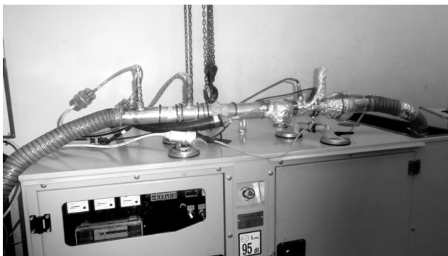
Figura 3. Tubo de toma de muestras instalado en el escape del grupo electrógeno.
