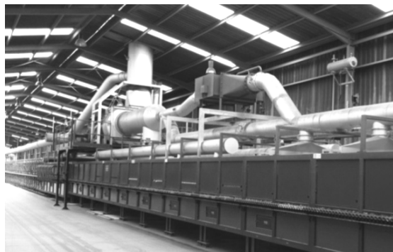
Figura 1: Instalación de recuperación de calor residual: (a) horno cerámico con intercambiador de calor, (b) esquema del conjunto del sistema.
