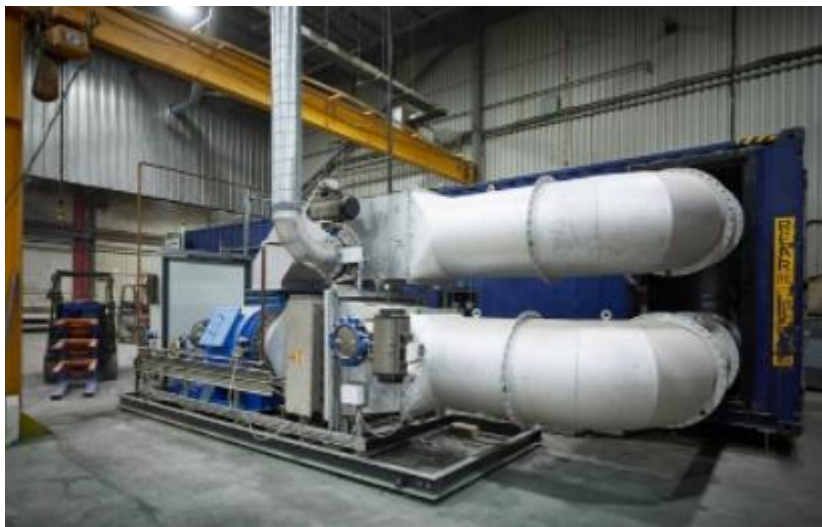
Figura 4.2.1: Cámara de absorción especializada. Proceso de curado con \text{CO}_2 [54].
