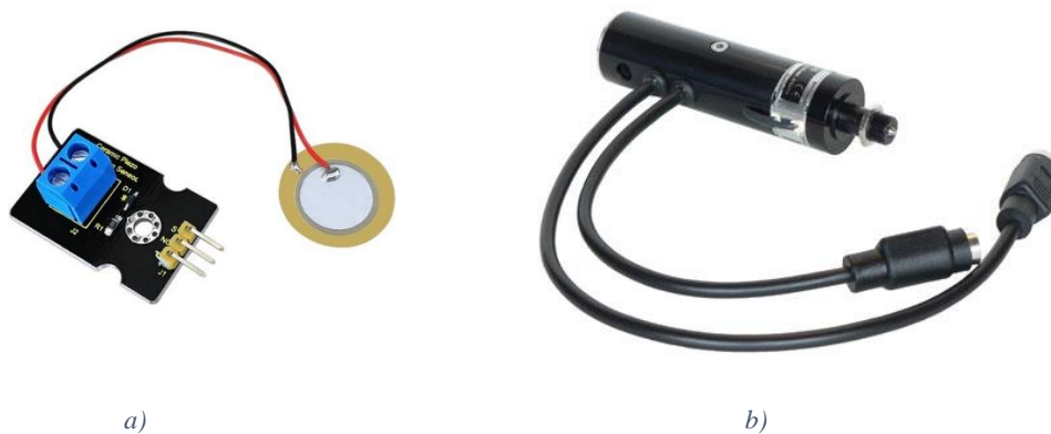
Figura 1.2. Aplicaciones de materiales piezoeléctricos a) Sensor b) Actuador
