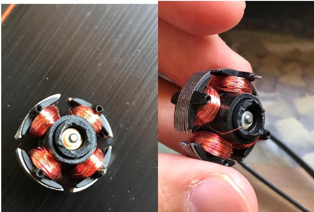
Figura 35. Imagen del núcleo del estator con sus correspondientes solenoides y núcleos metálicos
