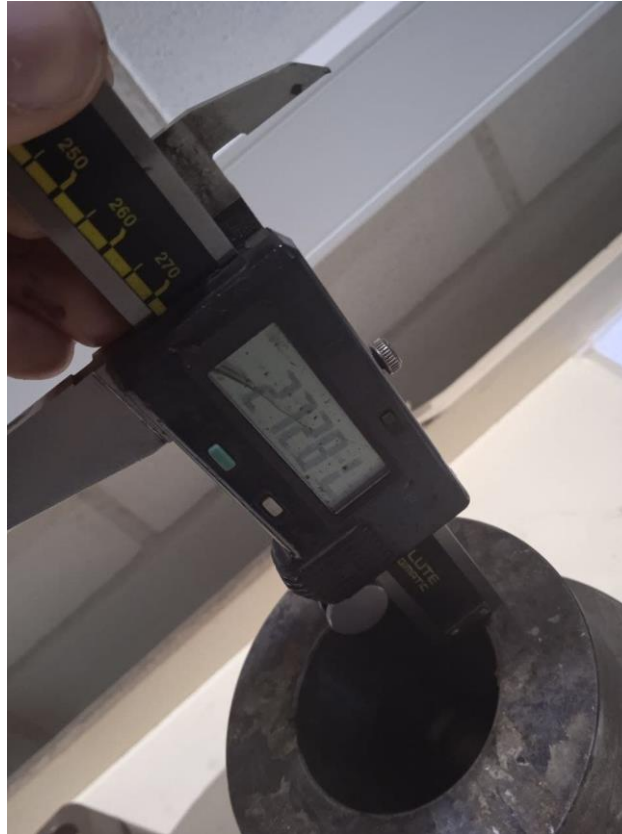
Figura 3.16 Longitud de la cámara de inyección
