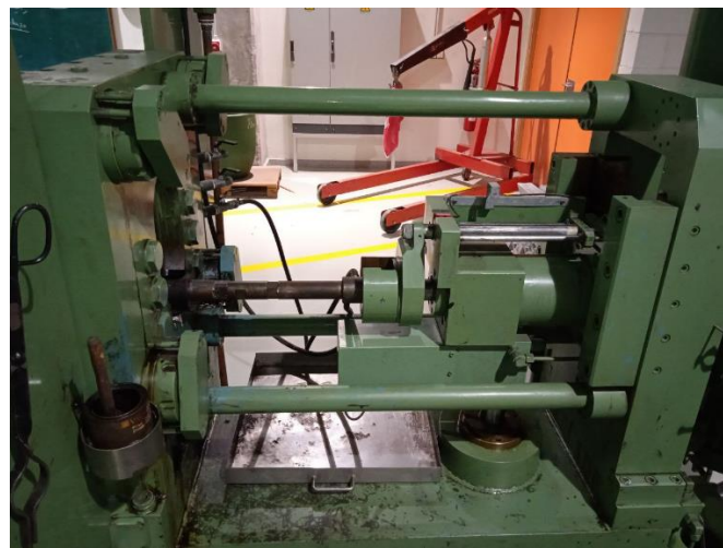
Figura 3.10 Vista general del sistema de inyección
