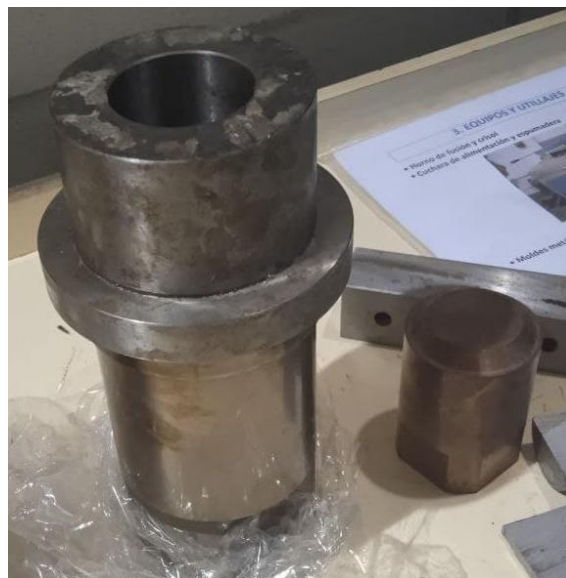
Figura 3.12 Juego completo de cilindro, casquillo y cámara de inyección
