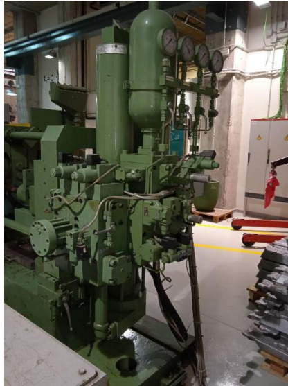
Figura 3.3 Depósitos del sistema de inyección
