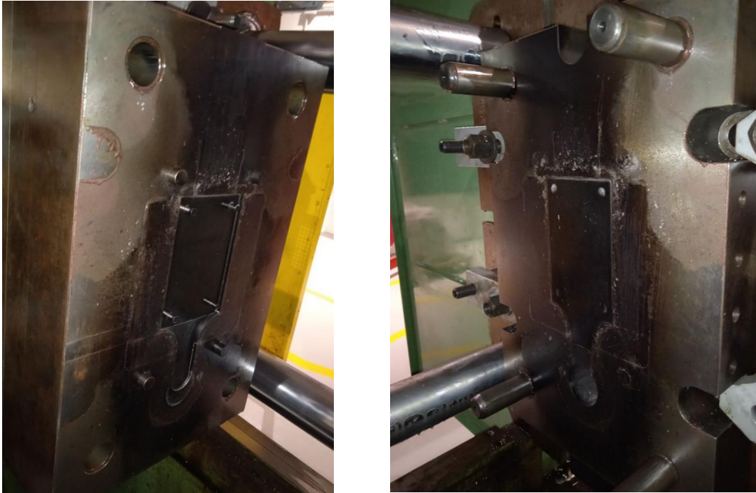
Figura 3.8 Parte móvil (izquierda) y fija (derecha) del molde
