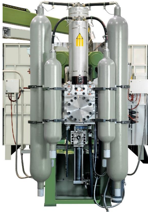
Figura 1.6 Bomba que proporciona la presión al sistema de inyección [25]
