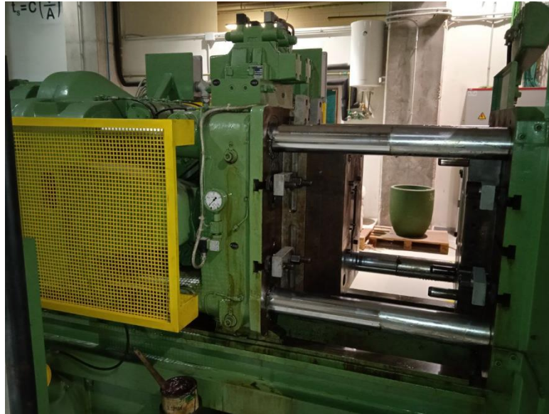
Figura 3.7 Parte fija y móvil del sistema de sujeción del molde
