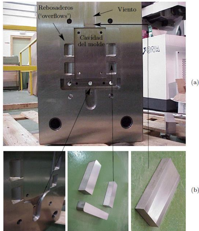
Figura 1.5 (a) Molde disponible en la UPCT e (b) insertos mecánicos intercambiables empleados para modificar la geometría del sistema [14]
