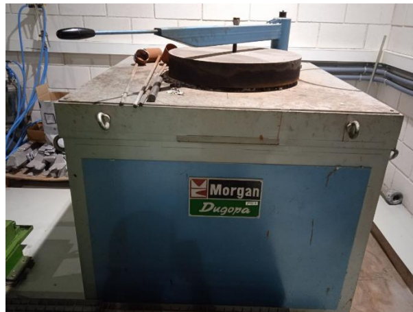
Figura 3.4 Horno de fusión y cucharas de colada
