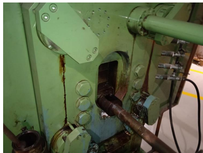
Figura 3.11 Detalle de la cámara de inyección y entrada al molde
