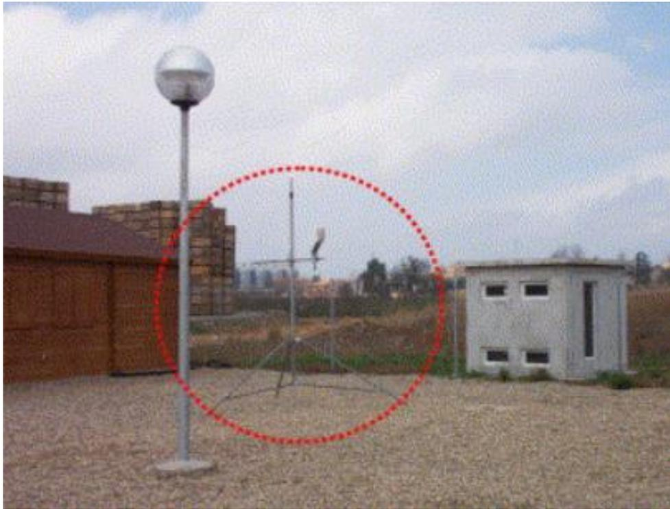
*Figura 15. Estación meteorológica*
