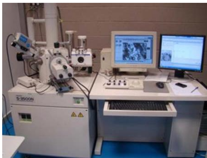
Figura 10. Equipo Hitachi S-3500N empleado en el análisis SEM de caracterización de bioadsorbente HO-AMINA
