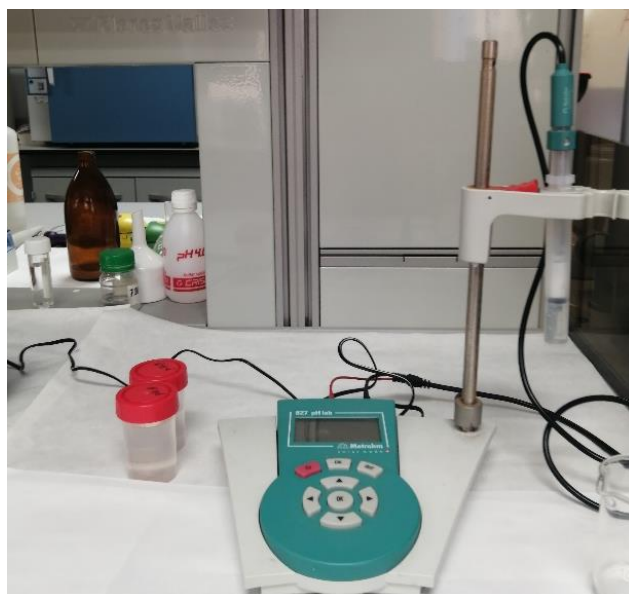
Figura 14. Equipo Metrohm (827 pH lab) empleado para medir el pH
