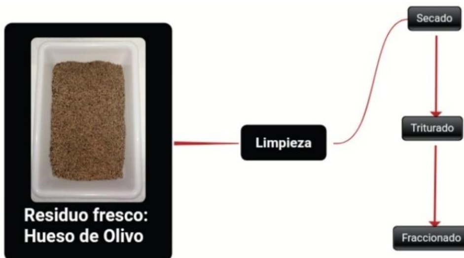
Figura 7. Pretratamiento de residuo lignocelulósico: Hueso de Olivo
