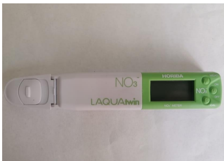
Figura 13. Sonda LAQUAtwin (HORIBA) empleado en la medición de \text{NO}_3^-
