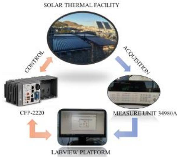
Figura 25. Elementos de adquisición y control. Fuente: Antonio Zamora [11]
