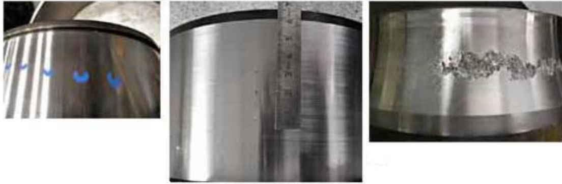
Figura 25. Ejemplos de tipos de rodamientos que pueden verse afectados (de izquierda a derecha): rodamiento de rodillos cónicos, rodamiento de rodillos cilíndricos, rodamiento de rodillos esféricos [44].
