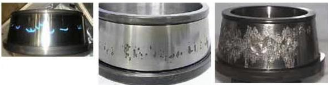
Figura 24. Distintas fases del deterioro del aro interior de rodamientos.
