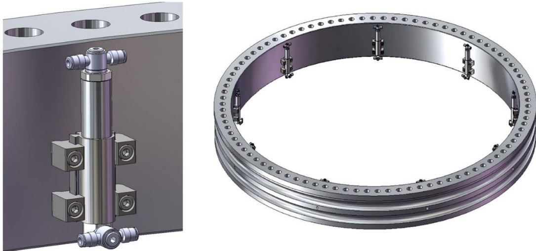
Figura 33. Instalación del sistema de lubricación
