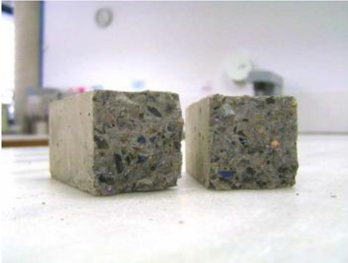
Ilustración 9. Adición de residuos de vidrio al hormigón [37].
