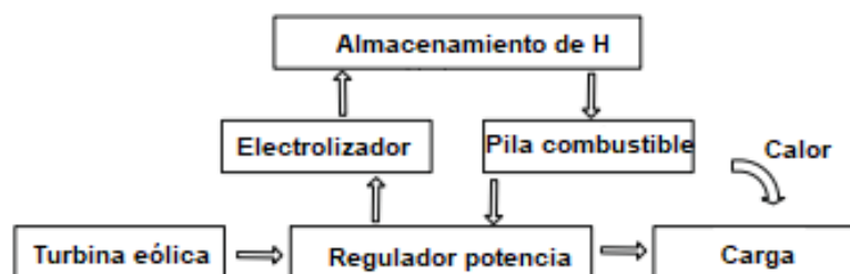
Figura 24: Diagrama del sistema viento-hidrógeno ( Khan & Iqbal, 2009 )
