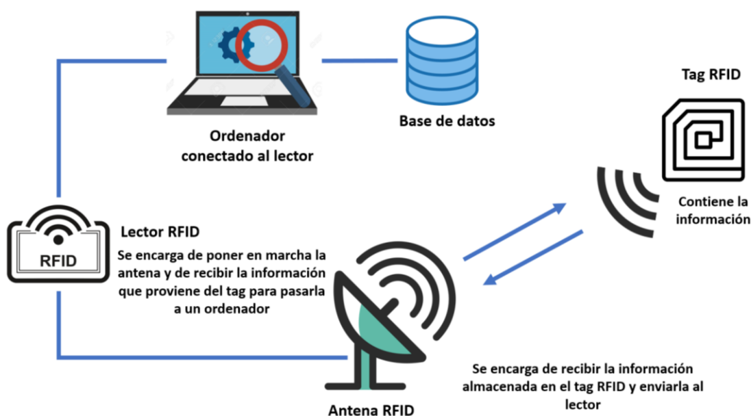
Figura 1.1. Partes de un sistema RFID
