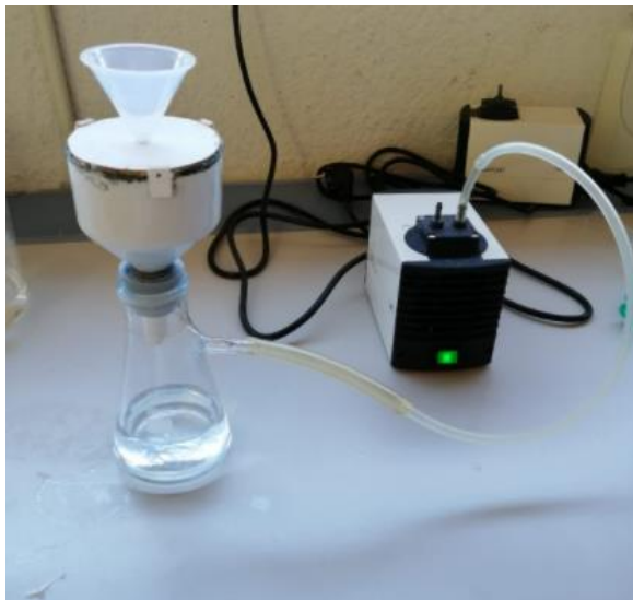
Figura 5.1.1. Medio adsorbente conectado a bomba de vacío.
