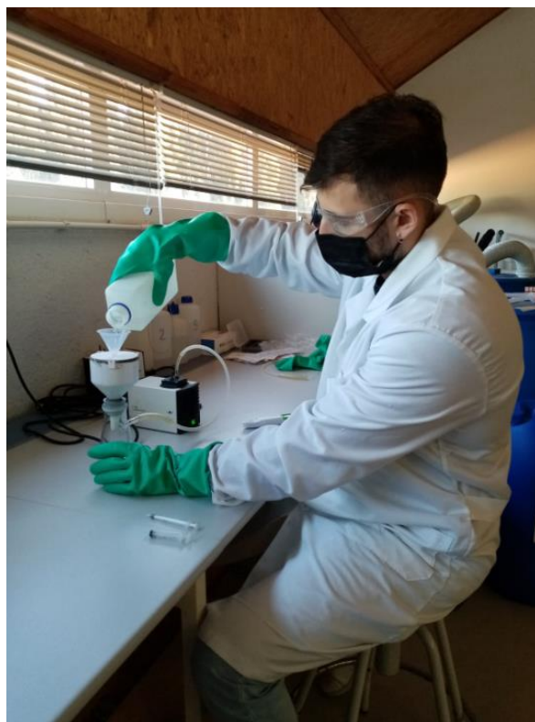
Figura 5.2.7. Proceso de lavado del medio adsorbente con HCl.
