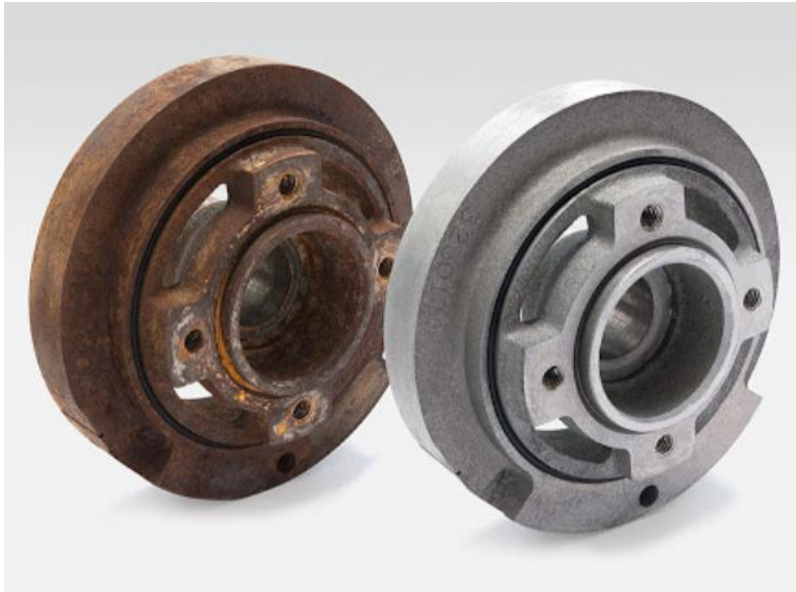
Figura 4.6.1. Pareja de rodamientos, antes y después de operación de decapado con HCl.
