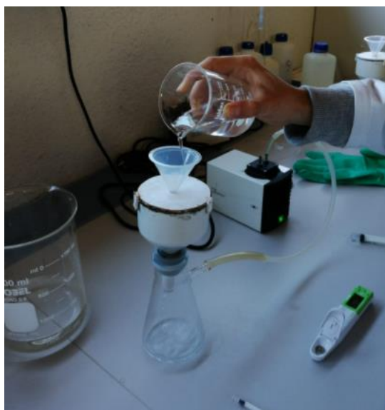
Figura 5.2.4. Introducción de una de las muestras en el medio adsorbente.
