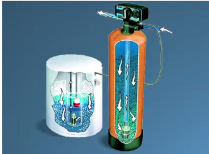
Figura 4.4.1. Ilustración gráfica descalcificador de sal con depósitos para resina y sal.
