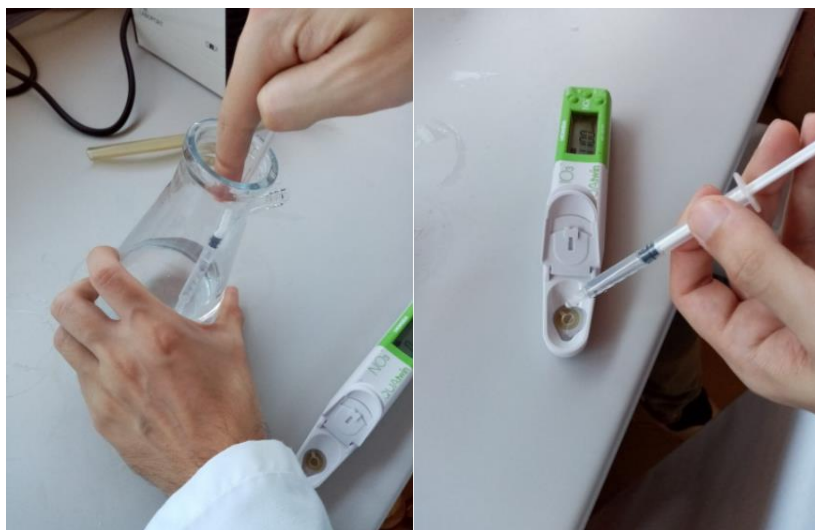
Figura 5.2.6. Extracción del medio adsorbente e introducción a la Horiba de una pequeña cantidad de la muestra.
