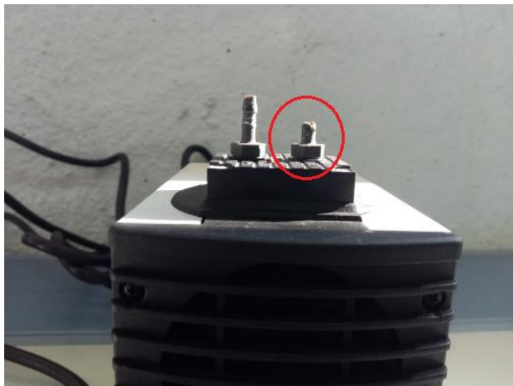
Figura 6.2.2. Saliente dañado debido al HCl en una bomba de vacío
