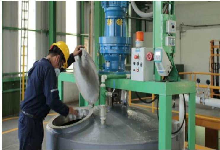
Figura 4.6.2. Operario de una planta alimenticia vertiendo ácido clorhídrico en un depósito.
