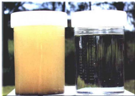
Figura 4.13 Muestra de agua procedente de una industria textil, antes y después de su tratamiento por electrocoagulación y filtración.
