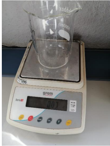
Figura 5.2 Peso electrónico empleado para medir los gramos de \text{NaNO}_3
