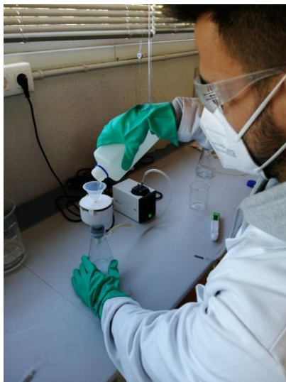
Figura 6.8 Manipulación del HCl siguiendo las correspondientes medidas de seguridad
