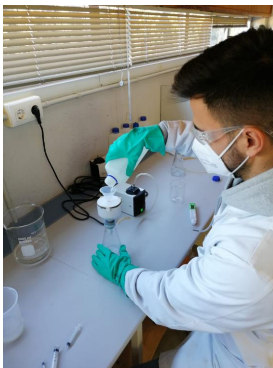
Figura 5.7 Proceso de lavado con HCl con las correspondientes medidas de seguridad
