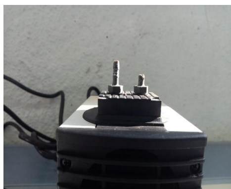
Figura 6.10 Pieza dañada de la bomba de vacío debido a la corrosión por HCl
