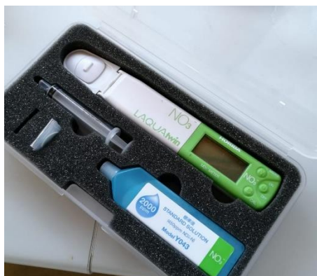
Figura 5.4 Medidor de nitratos (HORIBA LAQUAtwin NO 3 -11)
