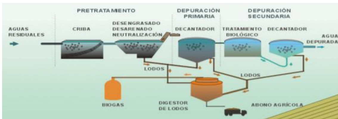
Figura 4.1 Proceso de lodos activos de flujo continuo o convencional
