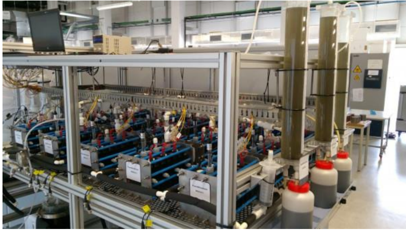
Figura 4.6 Prototipo de electrometanogénesis desarrollado por Leitat
