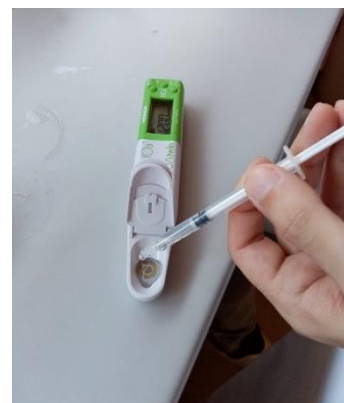
Figura 5.5 Proceso de medición de nitratos
