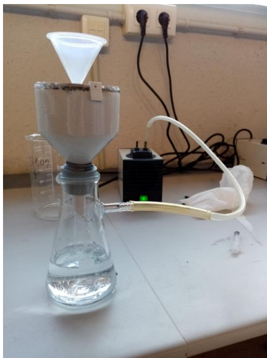
Figura 5.6 Medio adsorbente unido al kitasato conectado a la bomba de vacío
