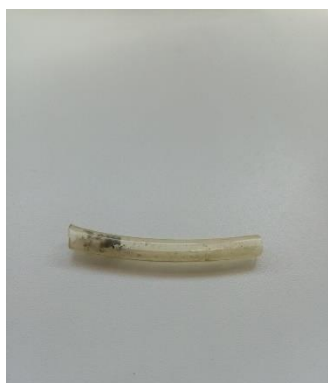
Figura 6.9 Porción dañada del conducto de conexión
