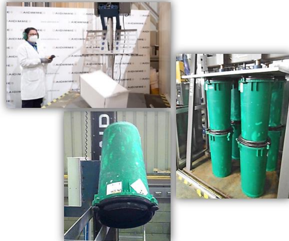
Figura 21. Ejemplos del ensayo de caída y de apilamiento en el Laboratorio de Mercancías Peligrosas de AIDIMME. [46]
