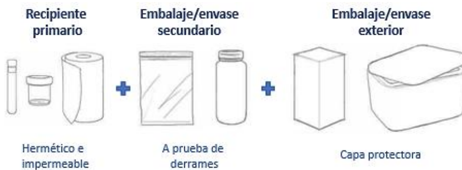
Figura 6. Ejemplo de un sistema de embalaje triple. [24]
