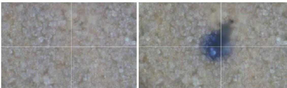
*Figura 38. Una fina capa de estructura metalorgánica, antes de la exposición (izquierda) y después de la exposición (derecha), con un láser de 785 nm de longitud de onda [45].*
