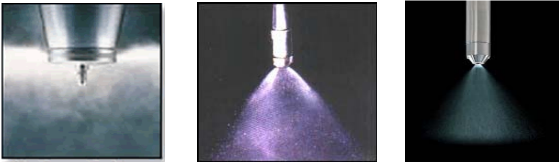
Figura 9. Por orden: imágenes de atomizador de rueda giratoria, boquilla a presión de un fluido y boquilla a presión de dos fluidos
