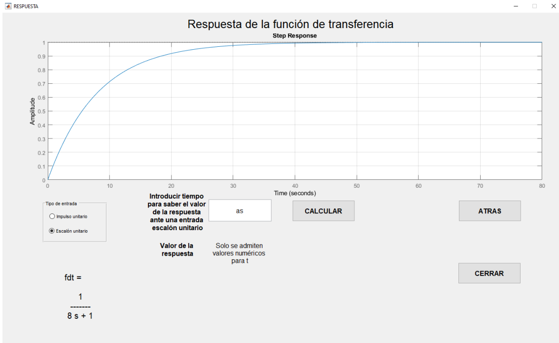
Figura 31: Respuesta ante escalón unitario fdt primer grado y t no numérico
