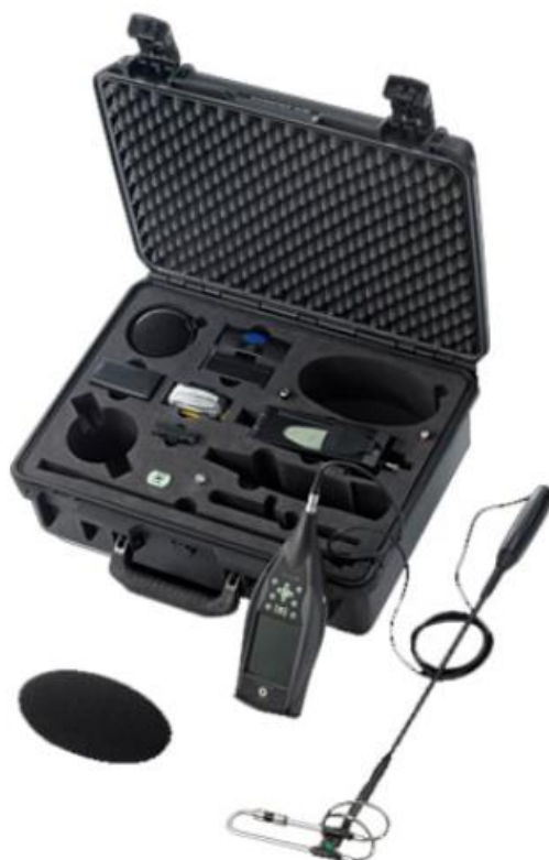
Figura 22: Kit de sonda para intensidad sonora
