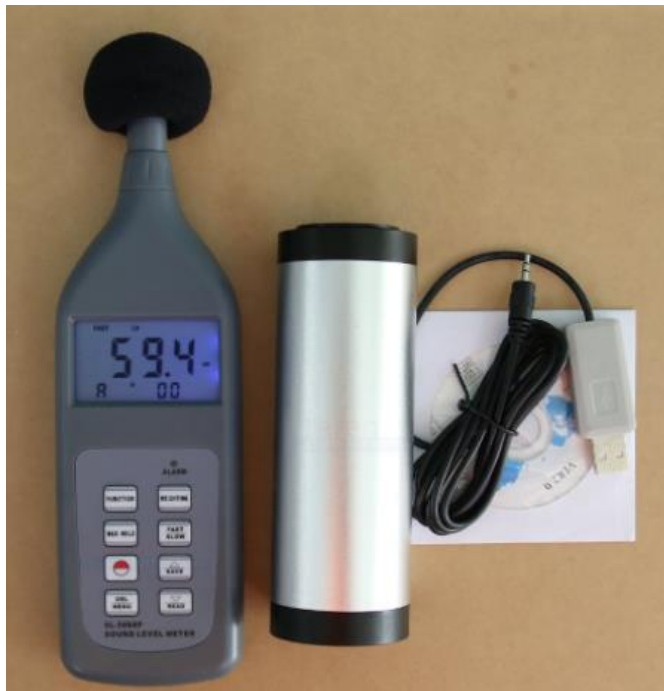
Figura 21: Medidor de nivel de sonido SL-5868p + Calibrador de medidor de nivel de sonido DN9b + software con cable USB.
