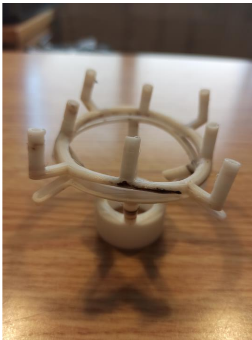
Figura 30. Aureola deformada tras ensayo (ABS).
