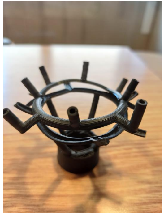
Figura 33. Aureola deformada tras ensayo (PETG).
