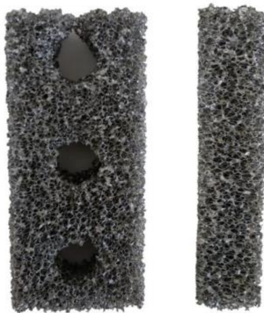
Figura 5. Ejemplar de espumas metálicas presentes en el acumulador aleteado.[3]
