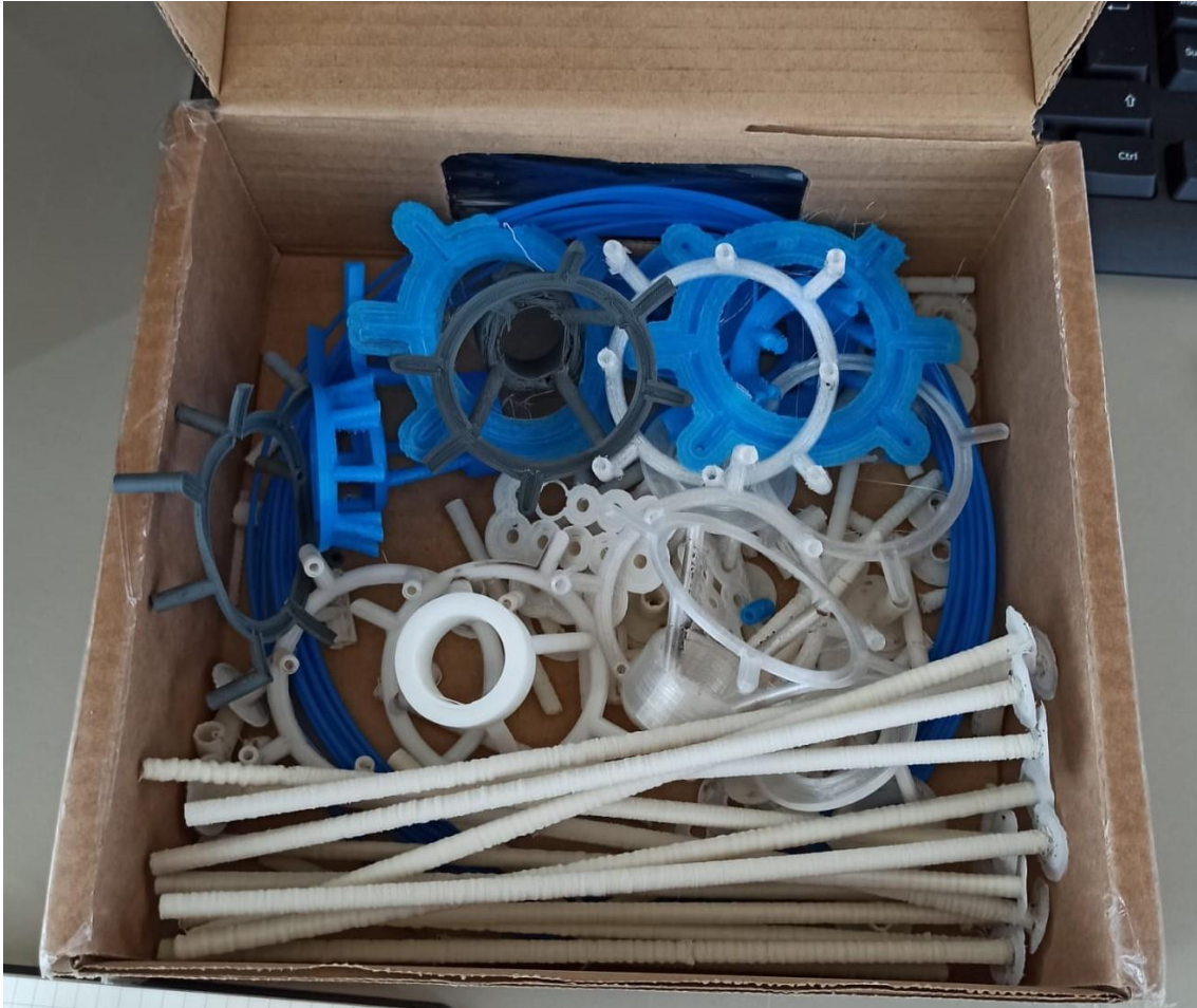
Figura 40. Entramado de instrumentación completamente impreso en 3D.
