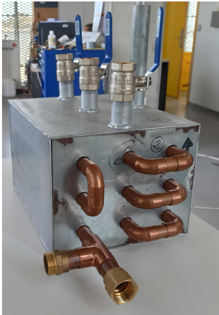
Figura 45. Acumulador ensamblado a la espera de fijación definitiva.
