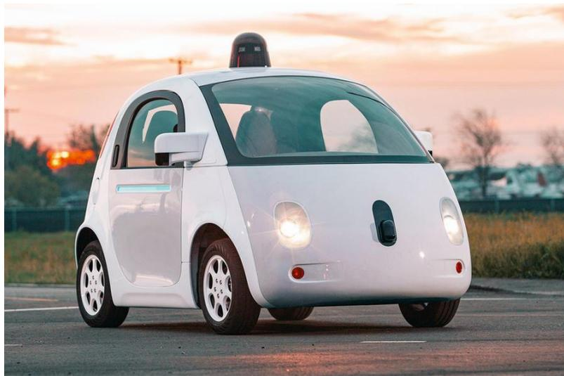
*Figura 2.4. Prototipo de vehículo autónomo SAE 4 desarrollado por Waymo.*
