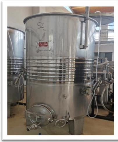
Ilustración 4: Depósitos con camisa de refrigeración.
