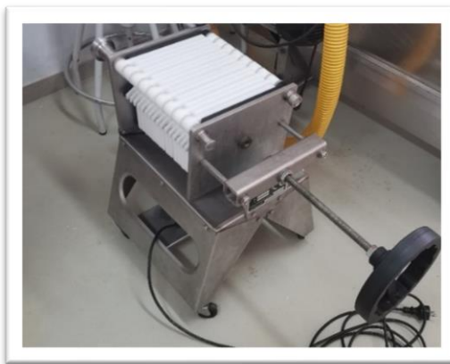
Ilustración 5: Filtro de placas.
