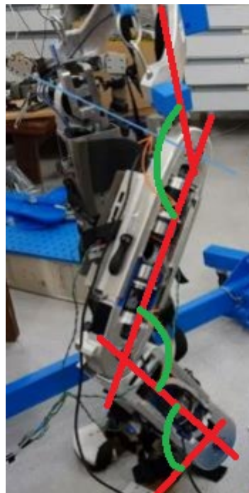
Ilustración 35. Exoesqueleto disponible en el Dpto. Automática, Ingeniería Eléctrica y Tecnología Electrónica (UPCT). Sobre el mismo, dibujadas las barras (en rojo) y marcadas los ángulos de cada articulación (en verde)
