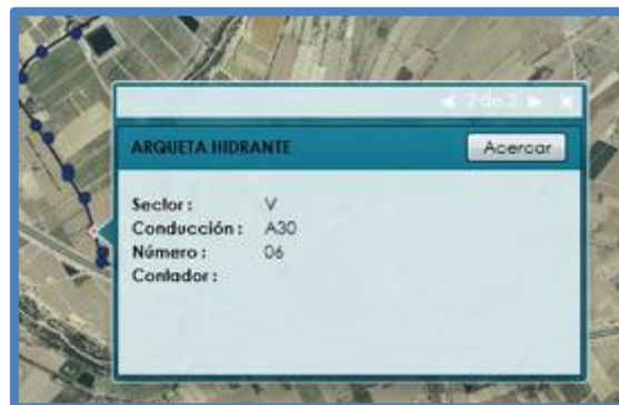
Figura 4. Resultado de una operación GetFeatureInfo sobre una arqueta hidrante
