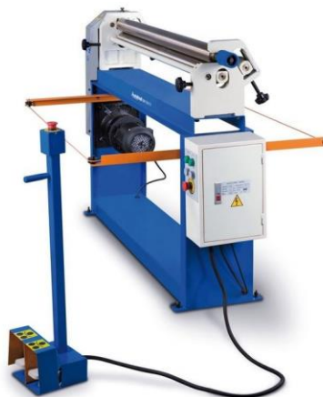
Figura 2. Curvadora RBM 1300-15 E de METALLKRAFT.
