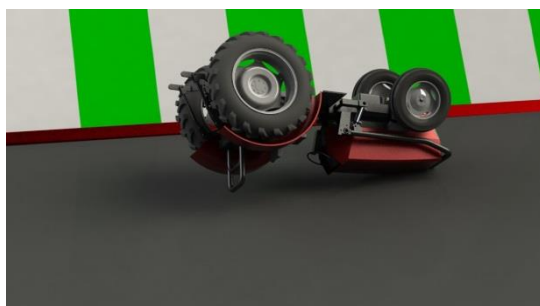
Figura 14: 1º) Choque con el arco abatido. 2º) Vuelta de campana (arco abatido)
