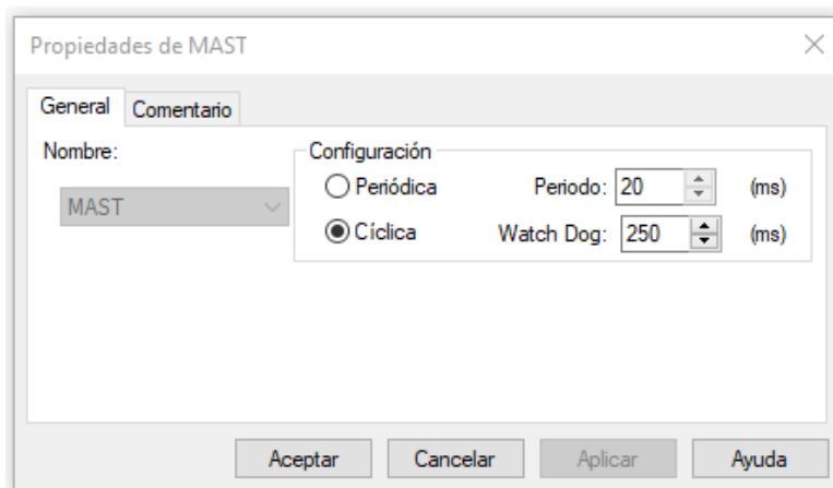
Figura 7-12 Configuración modo ejecución tarea
