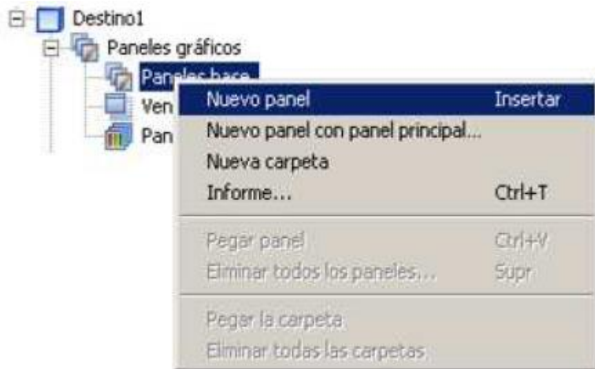
Figura 8-7 Creación de un nuevo panel
