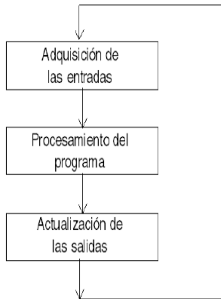
Figura 7-11 Proceso de ejecución de un scan (ciclo)
