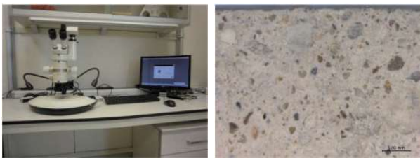
Figura 7. Fotografía de la lupa Leica MZ APO (izquierda) e imagen de la sección transversal de un revestimiento vista a través de la lupa con 10 aumentos (derecha) (V. La Spina).
