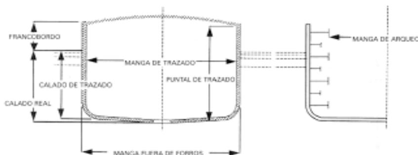
Figura 5.6 Esquema de manga, puntal y calado del buque.
