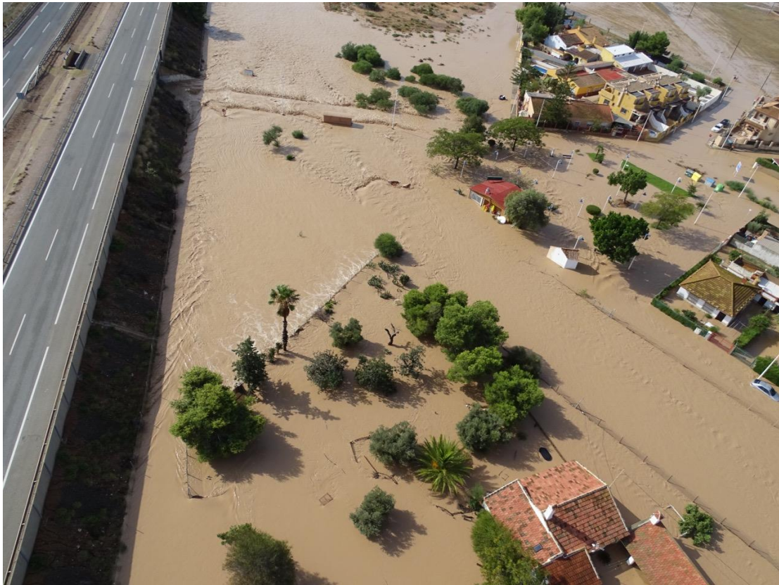
Figura 79. Vista aérea en detalle de una ODT. Efecto presa. Episodio DANA sept.2019. (Fuente: IMIDA,2019).
