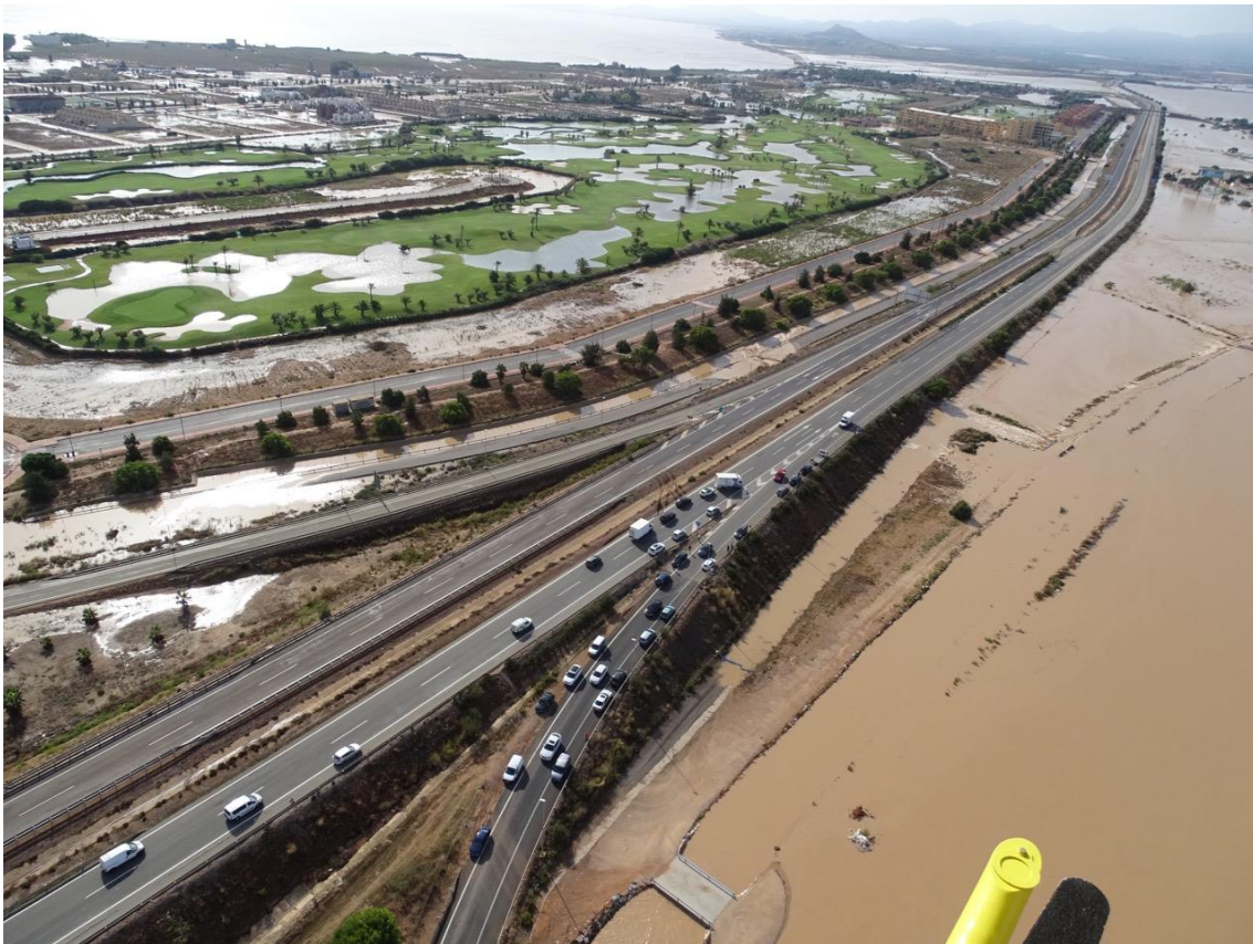
Figura 78. Vista aérea general de la zona de estudio. Efecto presa. Episodio DANA sept.2019. (Fuente: IMIDA,2019).
