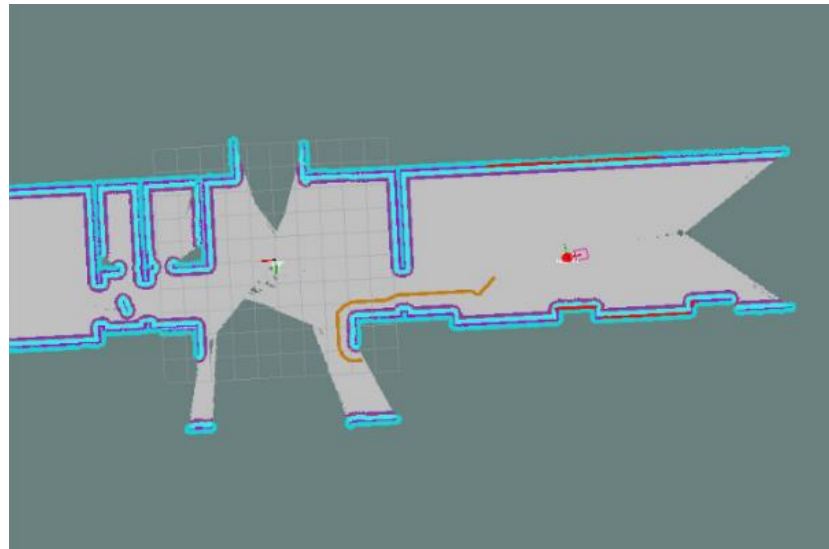
Figura 23. Generación de un mapa con el paquete de SLAM de Hector Mapping. Se puede apreciar como la tendencia es a mantener trazados rectos y estructuras poligonales.
