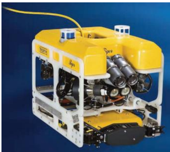
Figura 16. ROV SAAB SEA EYE TIGER. Fuente: www.marinevision.es
