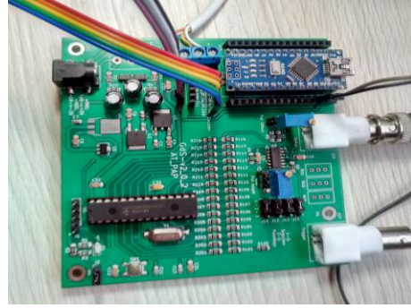
Fig. 41. PCB con casi todos los componentes soldados.
