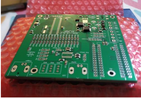
Fig. 40. PCB final con componentes soldados por JLCPCB
