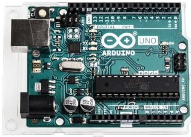
**Ilustración 2-8: Placa Arduino Uno Rev. 3.**
