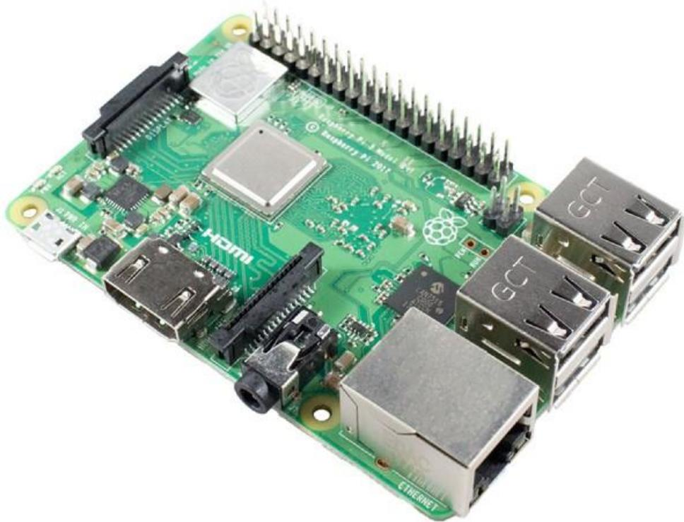
**Ilustración 2-7: Placa Raspberry Pi 3 Modelo B+.**
