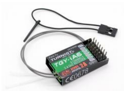
Figura 3.0.3 - 9: Receptor Turnigy TGY-iA6, de señal de radio
