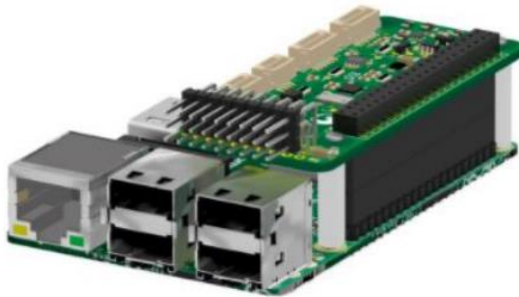
Figura 3.0.5 - 2: Unión de la Raspberry Pi 2 a la placa PXFmini
