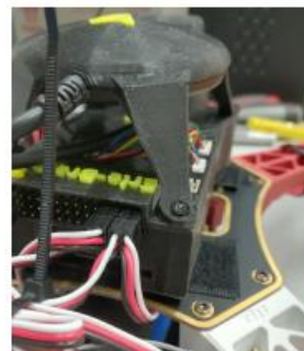
(b) Conexión de los ESCs al Erle-Brain
