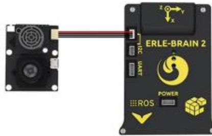
Figura 3.0.4 - 4: Conexión del Erle-Brain 2 al sensor de óptico PX4Flow
