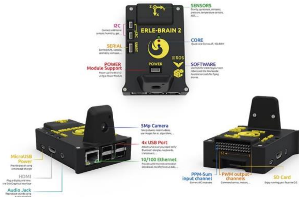
Figura 3.0.5 - 3: Conexiones pertenecientes al controlador Erle-Brain 2
