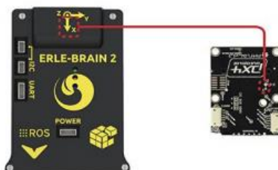
Figura 3.0.4 - 3: La adecuada orientación del sensor de flujo óptico
