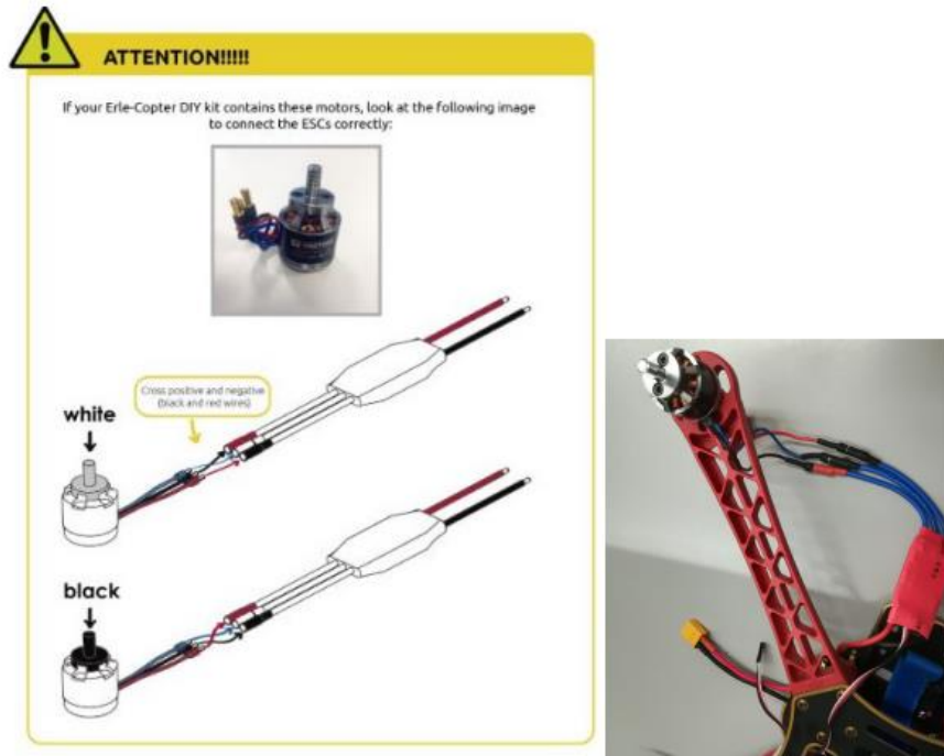
(a) Esquema conexión de los ESCs a los motores de Erle-Robotics
